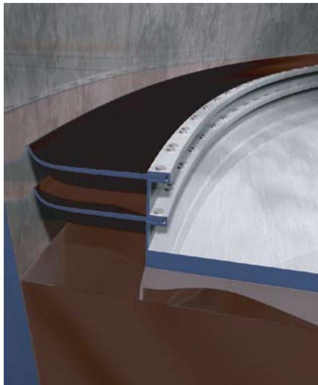
Sistema de sellado primario y secundario Wiper MesaWedge doble
